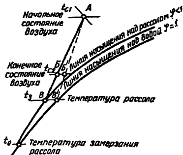
Рис. 7.51. Схема процессов тепло- и влагообмена в мокром воздухоохладителе при орошении воздуха соляным раствором
