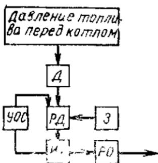
Рис. 14.7. Схема регулятора давления топлива перед горелками котлов типа ПТВМ с естественной тягой
