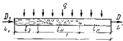
Рис. 7.12. Схема водопарового тракта прямооточного парогенератора
