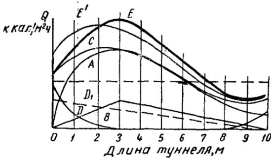
Рис. 89. Температурная кривая излучающего туннеля
