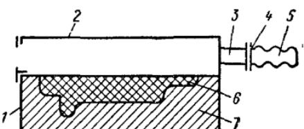
При формировании стержней из смеси ХТС ящики имеют патрубок для подключения к вытяжной вентиляции с помощью гибкого шланга. Вентиляция должна обеспечить скорость в открытом проеме ящика не менее 0,7 м/с. Учитывая взрывоопасность выделяющихся паров, количество удаляемого воздуха принимается таким, чтобы концентрации этих веществ были не более 50% нижнего предела взрывоопасности.
