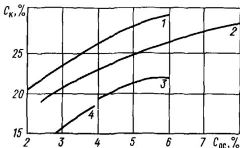
Рис. 6.7. Влияние концентрации сухого вещества в исходном осадке на эффективность задержания (центрифуга прогивоточная) при концентрациях сухого вещества в исходном осадке
