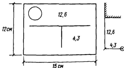
Рис. 5.3. Координатные таблички для канализационных колодцев
