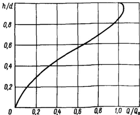
Рис. 5.4. График зависимости относительного наполнения от относительного расхода
