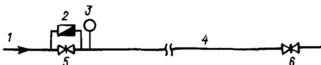
Рис. 3.9. Схема определения утечки воды манометром
