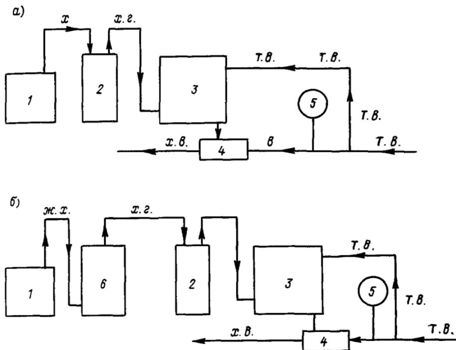
Рис. 4.1. Принципиальные схемы оборудования хлораторных
