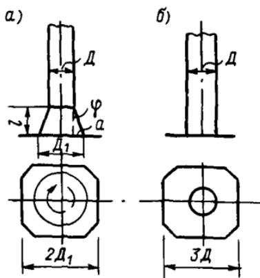
Рис. 3.1. Устройство диафрагм всасывающего трубопровода
