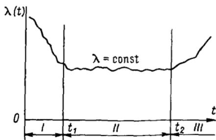
Рис. 2.1. Типичная кривая изменения интенсивности отказов во времени
