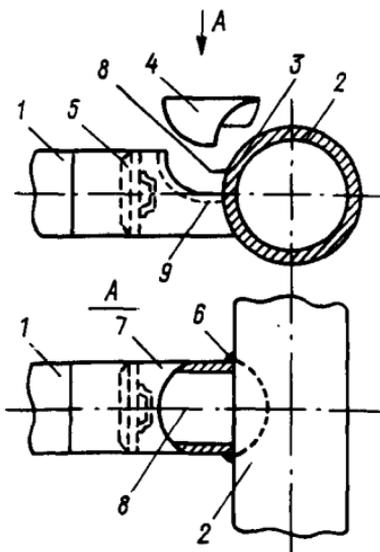
Рис. 8.1. Присоединение при помощи козырька
