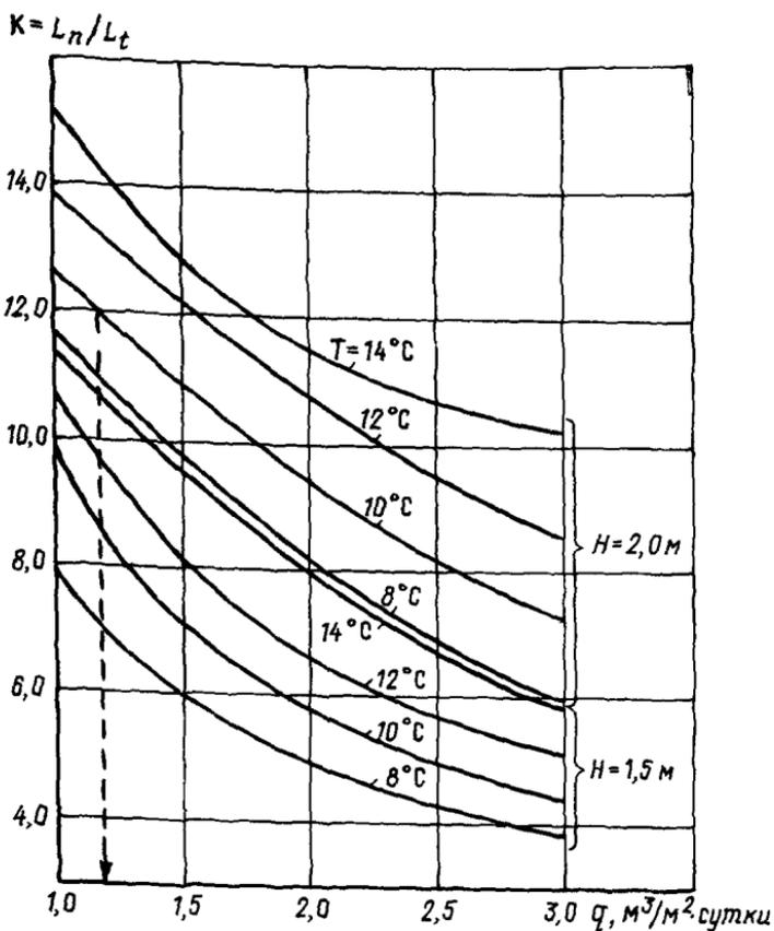
Рис. 6.3. Взаимозависимость параметров работы капельных биофильтров
