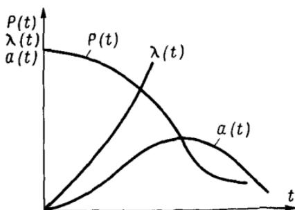
Рис. 2.4. Зависимость  $P(t)$ ,  $\lambda(t)$  и  $a(t)$  для нормального закона
