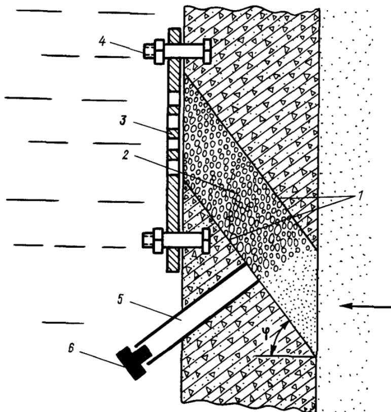
Рис. 3.2. Устройство водоприемной поверхности в шахтных колодцах
