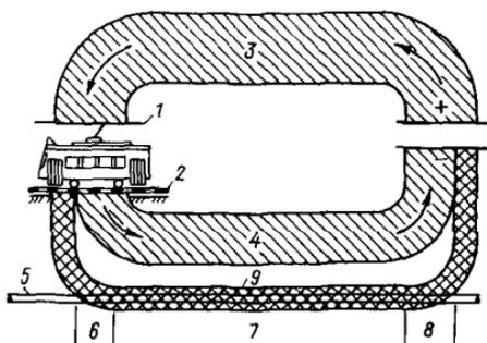
Рис. 3.14. Схема действия блуждающих токов
