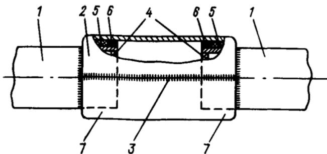
Рис. 8.2. Соединение при помощи разрезной муфты
