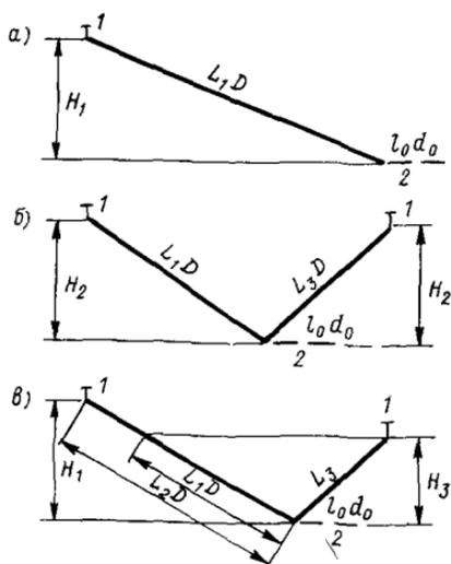
В повышенных местах водопроводных магистралей и в процессе эксплуатации, а также при пуске последних в трубопроводах образуются воздушные скопления, которые уменьшают живое сечение, повышают гидравлическое сопротивление и тем самым снижают пропускную способность труб. Удалить эти воздушные скопления можно при определенной скорости движения жидкости (м/с)
