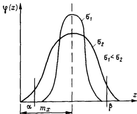
Рис. 2.3. Кривая плотности распределения для нормального закона
