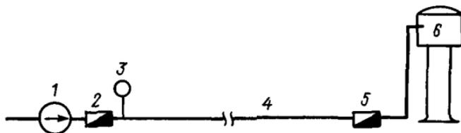
Рис. 3.7. Схема определения утечки воды водомерами
