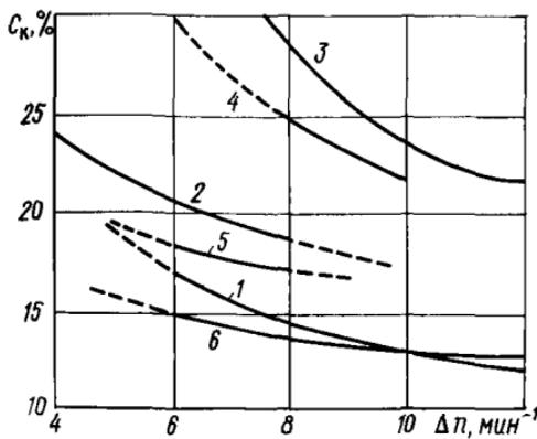
Рис. 6.14. Влияние относительной скорости вращения шнека на эффективность центрифугирования осадков сточных вод
