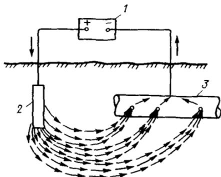
Рис. 3.13. Принцип действия катодной защиты
