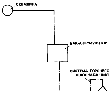
Рис. 17.4. Схема с непосредственной подачей геотермальной воды только на горячее водоснабжение
