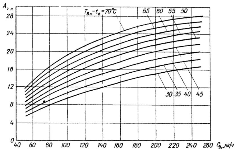
Лист VIII.15. Удельный показатель  $A_{T_K}$  в двухрядном теплообменнике ЭКД при последовательном соединении двух теплообменников по воде и по воздуху.
