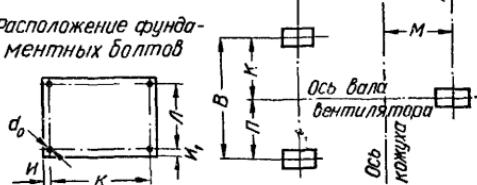
Лист VII.21. Принципиальные схемы конструктивного исполнения центробежных вентиляторов:
