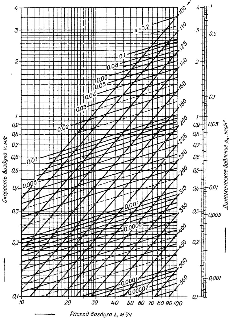
Лист VII.7. Номограмма для расчета круглых стальных воздухопроводов при расходах воздуха до  $100 \text{ м}^3/\text{ч}$  (при  $K = 0,1$ ;  $\gamma = 1,2 \text{ кг}/\text{м}^3$ ).
